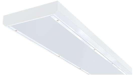
LED-Aufbauleuchte, Serie HAWK Sport, IP43, für Einsatz in Sport- und Turnhallen und Sportplatzanlagen. Ballwurfsicher nach DIN 18032-3. Gehäuse aus Stahlblech, pulverbeschichtet. Diffusor aus PC, UV-resistent. Netzteil, schaltbar oder DALI dimmbar, integriert. Ausführung mit Casambi Bluetooth Steuerung verfügbar. DC tauglich. NANO Schutz auf Anfrage.
