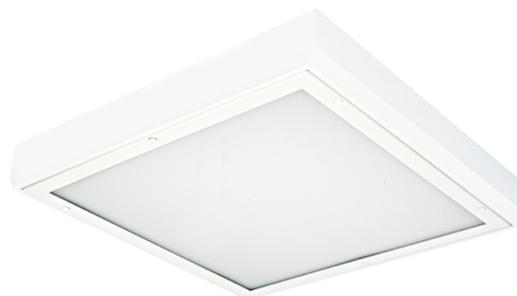
Luminaire LED à encastrer ou à monter en saillie, série LINDO, IP65, pour installation dans zones à critères élevés (hôpitaux, laboratoires, salles d'opération, industrie agro-alimentaire, etc.). Boîtier en tôle d'acier, avec revêtement par poudre. Diffuseur en PMMA, résistant aux UV. Bloc d'alimentation, commutable ou intensité variable DALI, intégré. Modèle disponible avec commande Bluetooth CASAMBI®. Compatible DC. Protection NANO sur demande.
