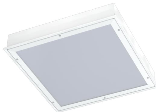
Luminaire LED à encastrer ou à monter en saillie, série LINDO, IP65, pour installation dans zones à critères élevés (hôpitaux, laboratoires, salles d'opération, industrie agro-alimentaire, etc.). Boîtier en tôle d'acier, avec revêtement par poudre. Diffuseur en PMMA, résistant aux UV. Bloc d'alimentation, commutable ou intensité variable DALI, intégré. Modèle disponible avec commande Bluetooth CASAMBI®. Compatible DC. Protection NANO sur demande.
